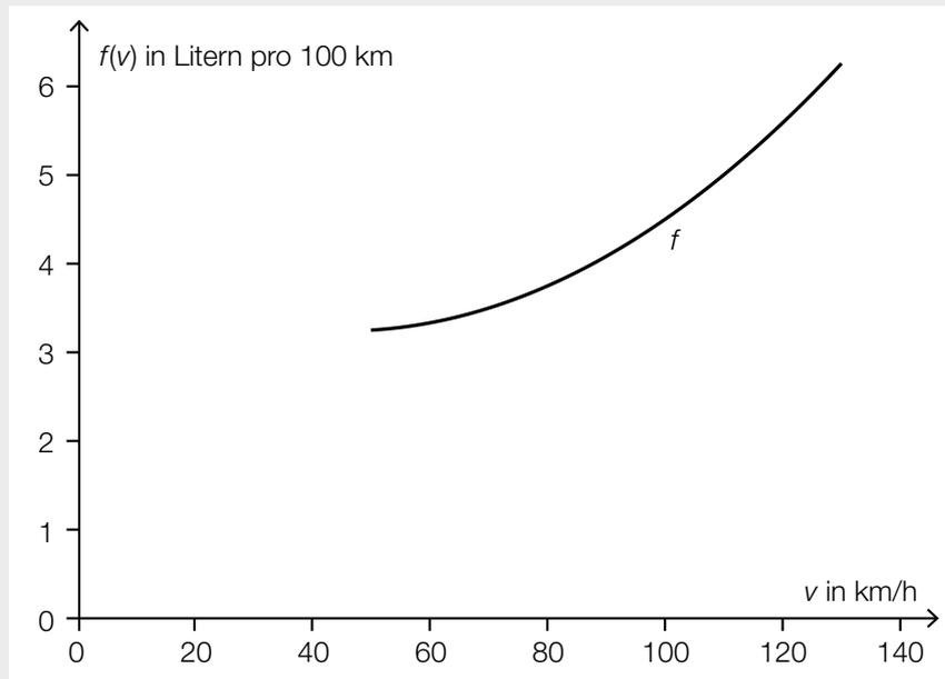
(R): Bei einer Geschwindigkeit von 120 km/h ist der Treibstoffverbrauch (in Litern pro 100 km) um rund 59,7 % höher als bei 70 km/h.
