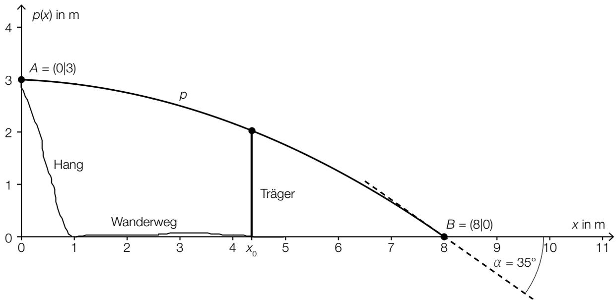
Diese Profillinie kann zwischen den Punkten  $A$  und  $B$  mithilfe der quadratischen Funktion  $p$  mit  $p(x) = a \cdot x^2 + b \cdot x + c$  beschrieben werden.
