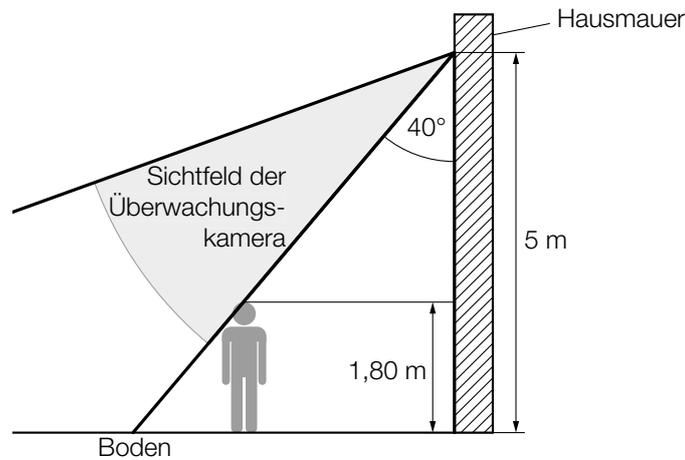
Eine 1,80 m große Person befindet sich genau am Rand des Sichtfelds der Überwachungskamera (siehe obige Abbildung).
