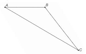
Zur Berechnung eines Winkels wird die folgende Formel verwendet:  $\cos(\phi) = \frac{\overrightarrow{AB} \cdot \overrightarrow{BC}}{|\overrightarrow{AB}| \cdot |\overrightarrow{BC}|}$
